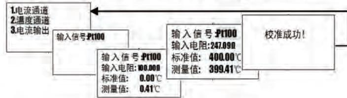
2. 校准完成自动返回电流通道初始界面。
