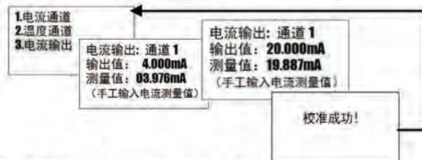
2. 校准完成自动返回电流通道初始界面。
